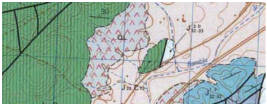
Imagen 2: Mapa geológico de la zona de ubicación de la cantera. Perteneciente a la hoja 571 del MAGNA. Los materiales explotados se identifican en el mapa con las siglas J2-C11. Imagen obtenida de la página web publicada por el Instituto Geológico y Minero de España.
