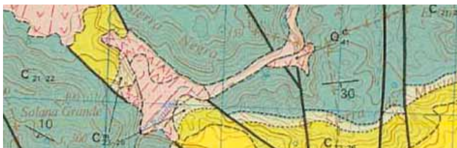
Imagen 2. Mapa geológico de la zona de ubicación de la cantera de Áridos El Vedat. Perteneciente a la hoja 796 (Gandía) del MAGNA. Los materiales explotados se identifican en el mapa con las siglas C 21-22. Imagen obtenida de la página web publicada por el Instituto Geológico y Minero de España. ( http://www.igme.es/internet/cartografia/cartografia/datos/magna50/jpg/d7_jpg/Editado_MAGNA50_796.jpg )
